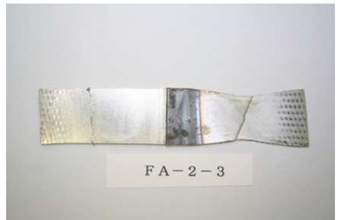
図14 継手引張試験後のレーザーロール溶接継手（母材破断。破断強度 330MPa）
